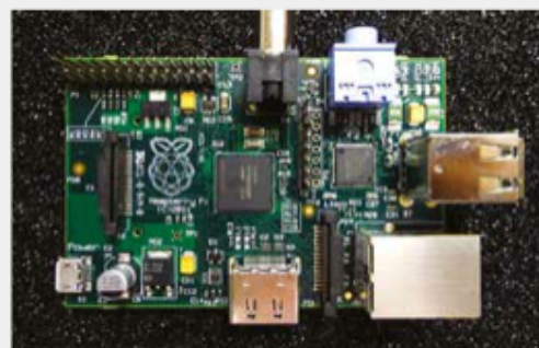
UNA SCHEDA RASPBERRY PI VERSIONE BETA: PRIMA DI HARD DISK, SI BASA SU UN SISTEMA (SOC) BROADCOM BCM2835 CON PROCESSORE ARM1176JZF-S A 700 MHz E SCHEDA VIDEO VIDEOCORE IV; PER QUANTO RIGUARDA LA RAM È DATO SCEGLIERE TRA DUE POSSIBILITÀ, 256 O 512 MB.
